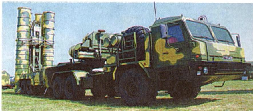
Пусковая установка ЗРС «Триумф» с тягачом БАЗ-6402 .
