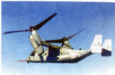
ма, удовлетворяющая самолетно-вертолетным условиям, — конвертоплан. «Гибридность» достигается изменением в полете положения гондол с турбовинтовыми двигателями — из вертикального в горизонтальное.
