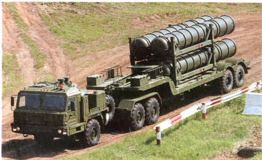
Тягач БАЗ-6402-015 в составе пусковой установки ЗРС С-400 «Триумф».
